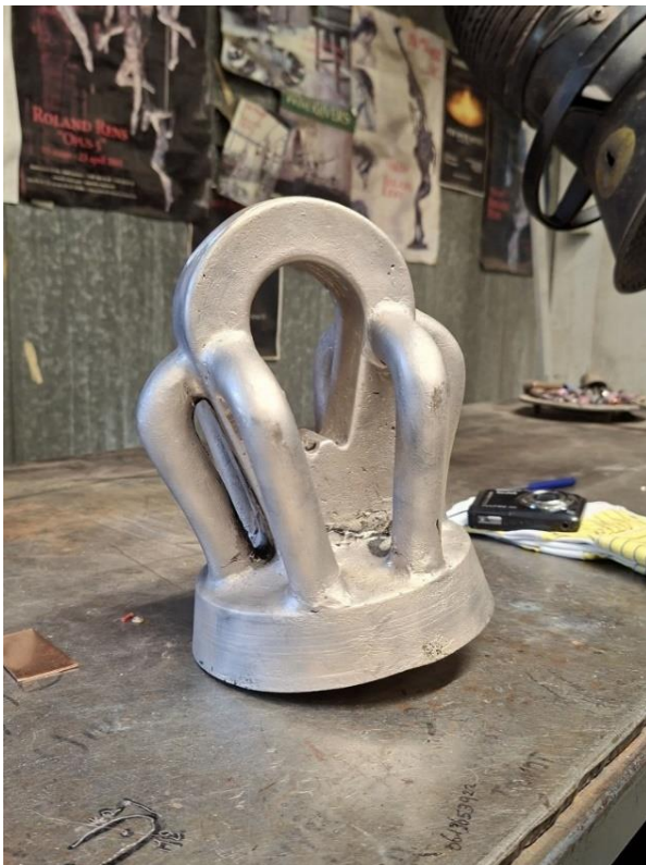
Bilder 9 und 10: Die neue Krone mit Halterung für den Klöppel
